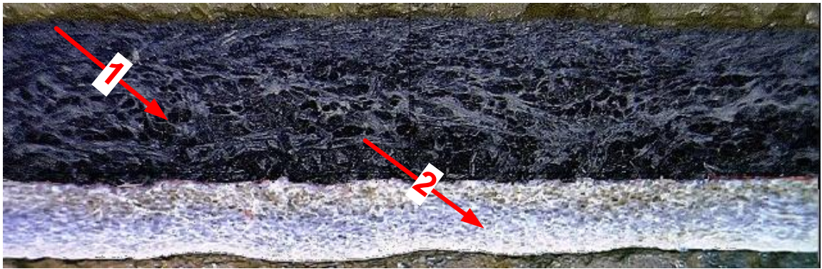
Рис. 3 Поперечный срез материалов (1) обуви: 1 – коженные волокна верха (1) обуви, 2 – коженные волокна подкладки
