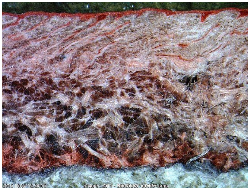
Рис. 5 Коженные волокна с пленочным покрытием верха (2) обуви
